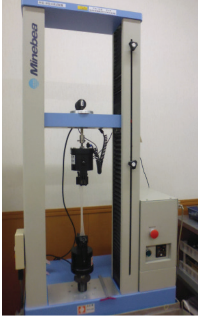
7. Máy kiểm tra tính cơ giãn của vải. Máy sẽ kéo giãn vải một cách tối đa. Bước này được thực hiện 3 lần.
